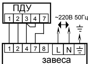
Подключить сетевой кабель и ПДУ согласно маркировке рядом с клеммной колодкой.
